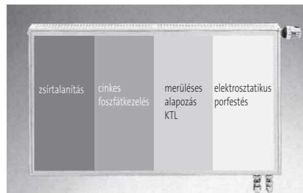
A radiátor elektrosztatikus felületkezelése
